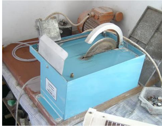
Слика 19. Тестера Lortone TS-8 на којој је извршено сечење узорка
