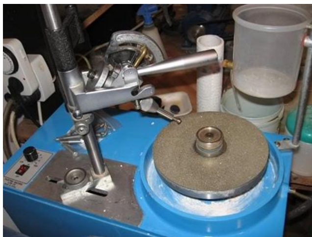
Слика 21. Машина на којој је извршено брушење и полирање равних површина јувелирских минералних сировина
