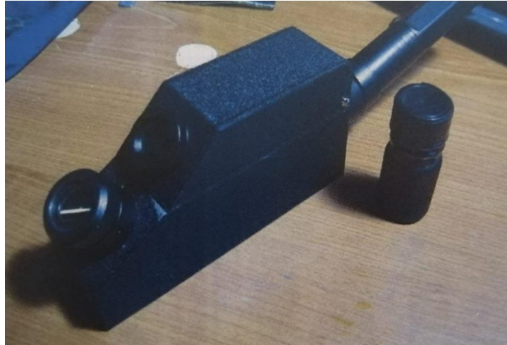
Слика 14. Рефрактометар CL-181 на којем су извршена испитивања.
