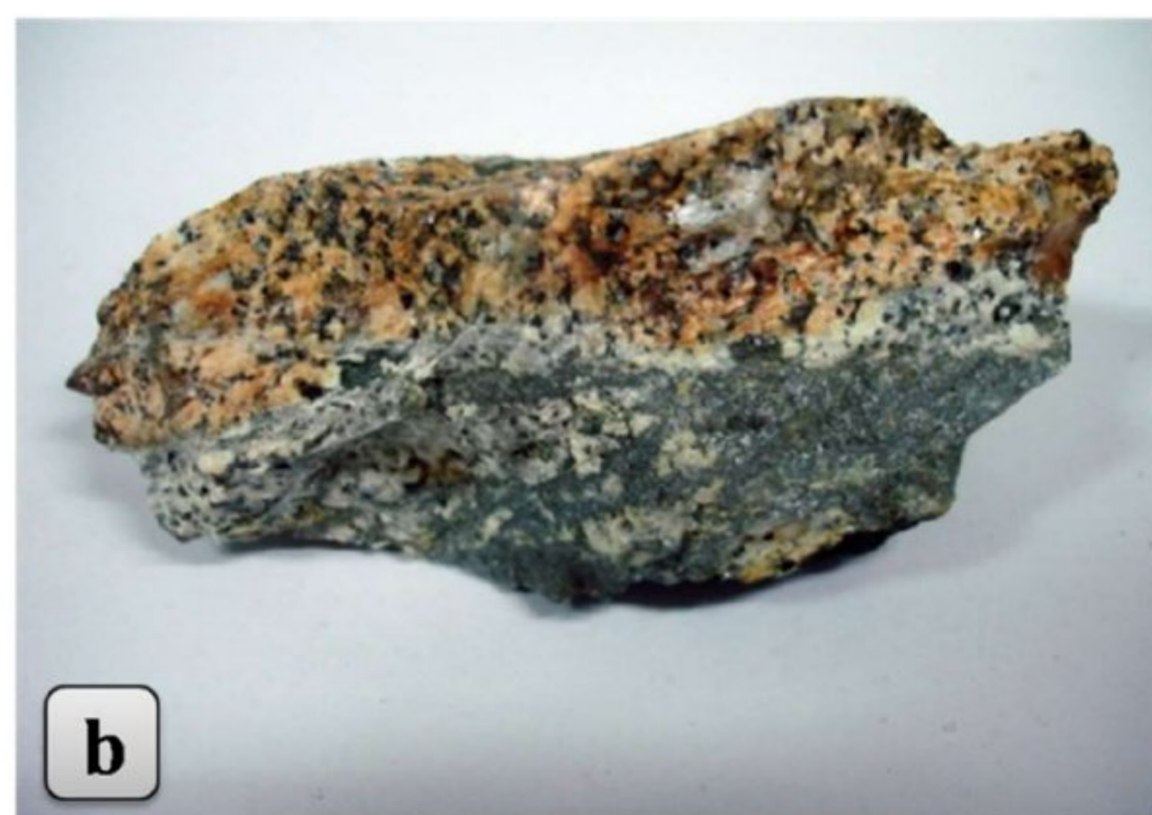
Slika 3.13. Rudne pojave u Golijaškoj reci: a) profil sa koga su uzeti uzorci; b) uzorak G.R.7.1 na kojem se zapaža pojava arsenopirita (sivo) u granitoidnoj steni (širina uzorka ~10 cm).
