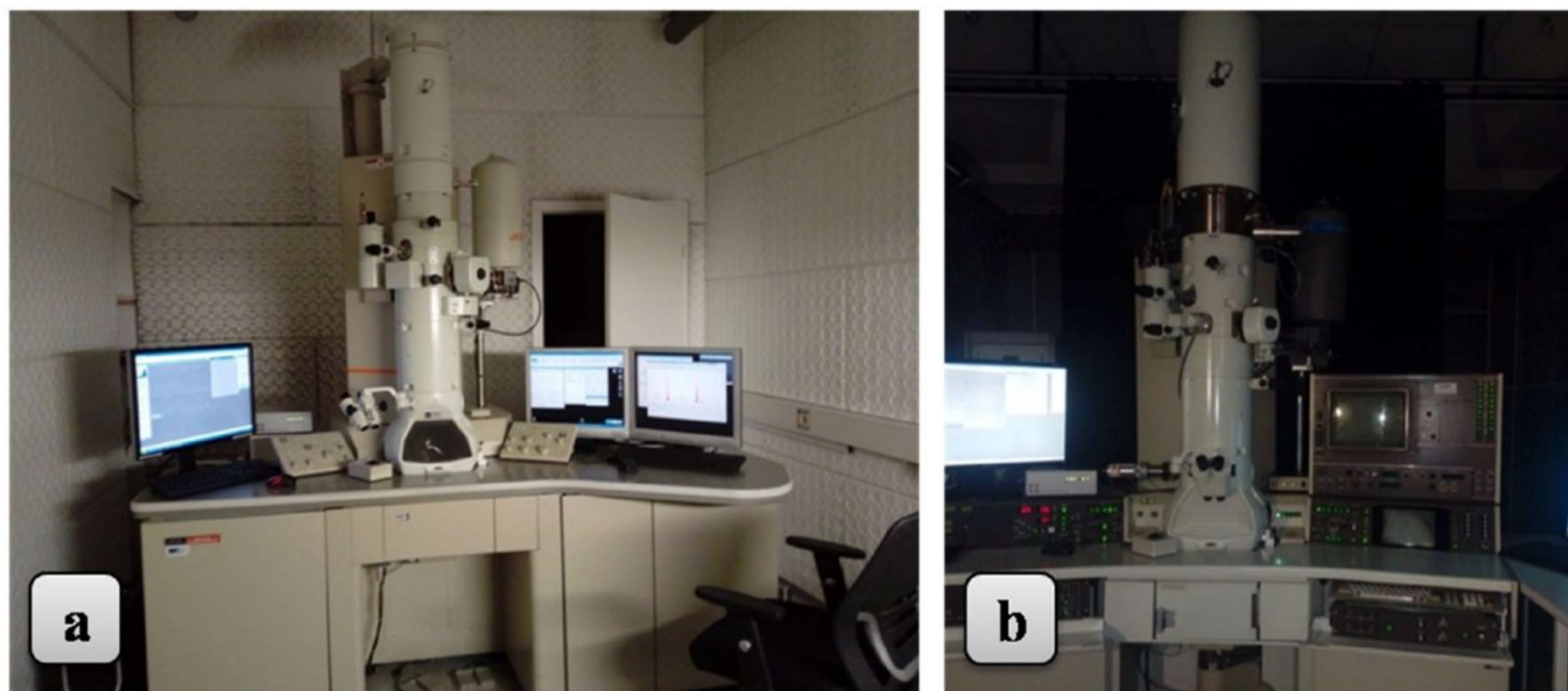
Slika 3.16. Transmisioni elektronski mikroskopi, Jožef Stefan Institut, Ljubljana, Slovenija: a) JEM-2100, JEOL opremljenim sa energetsko-disperzivnim spektrometrom rendgenskih zraka (EDS, EX 24063JGT, JEOL); b) JEM-2010F, opremljenim sa energetsko-disperzivnim spektrometrom (EDS – Oxford instruments, model Link Pentafed).
