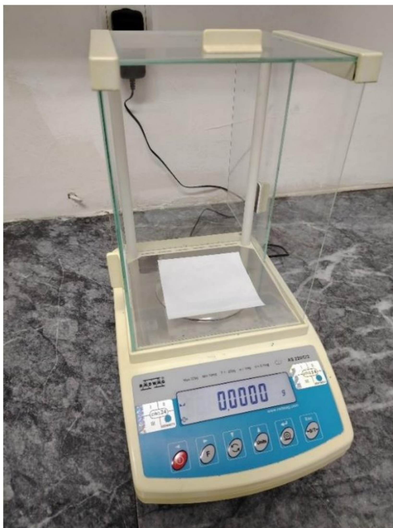
Slika 3.2 Analitička vaga za precizno merenje mase jedinjenja koja se koriste za sintezu.
