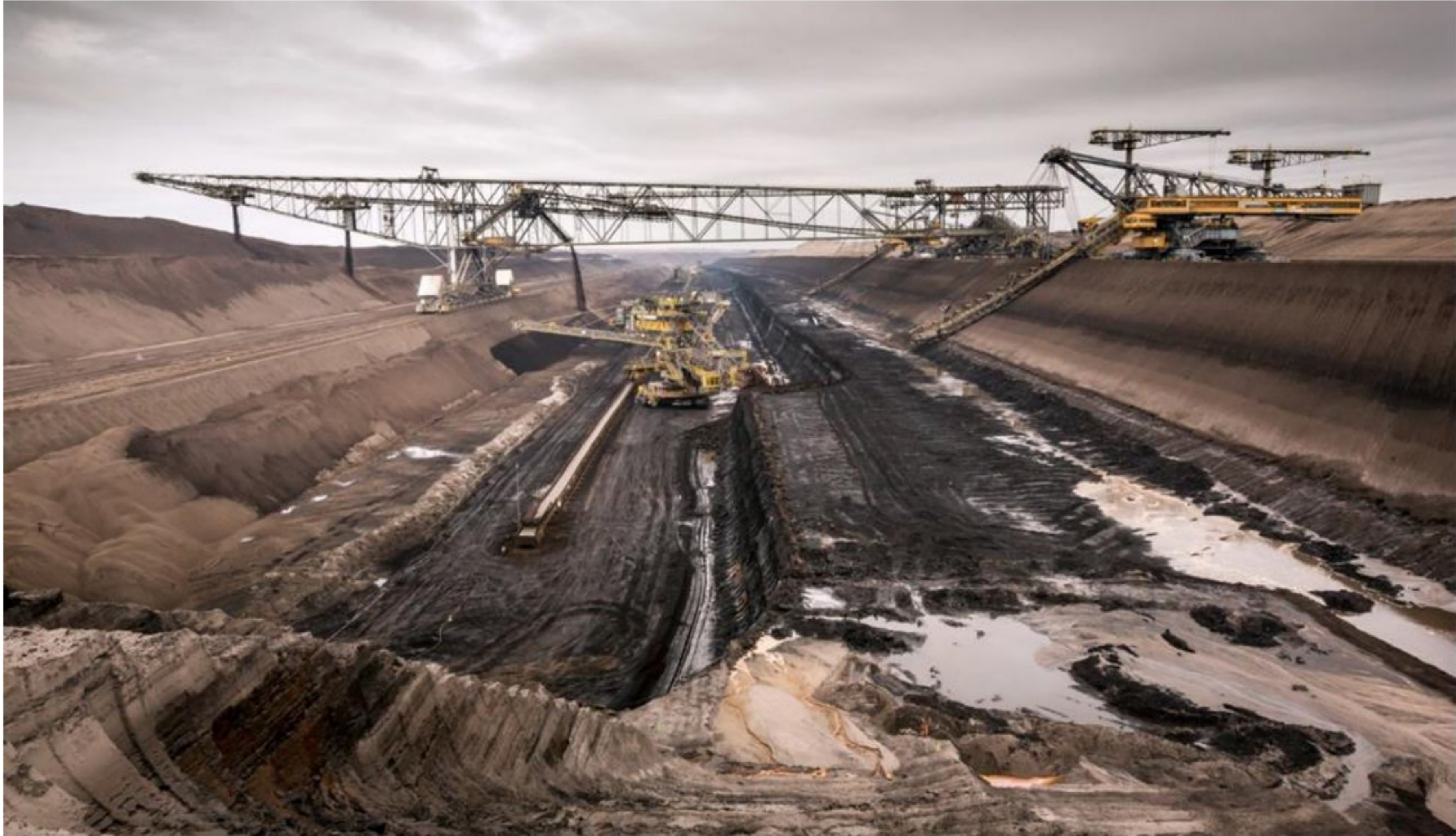
Слика 3.3.14 Одлагалиште формирано транспортним мостовима [58]
