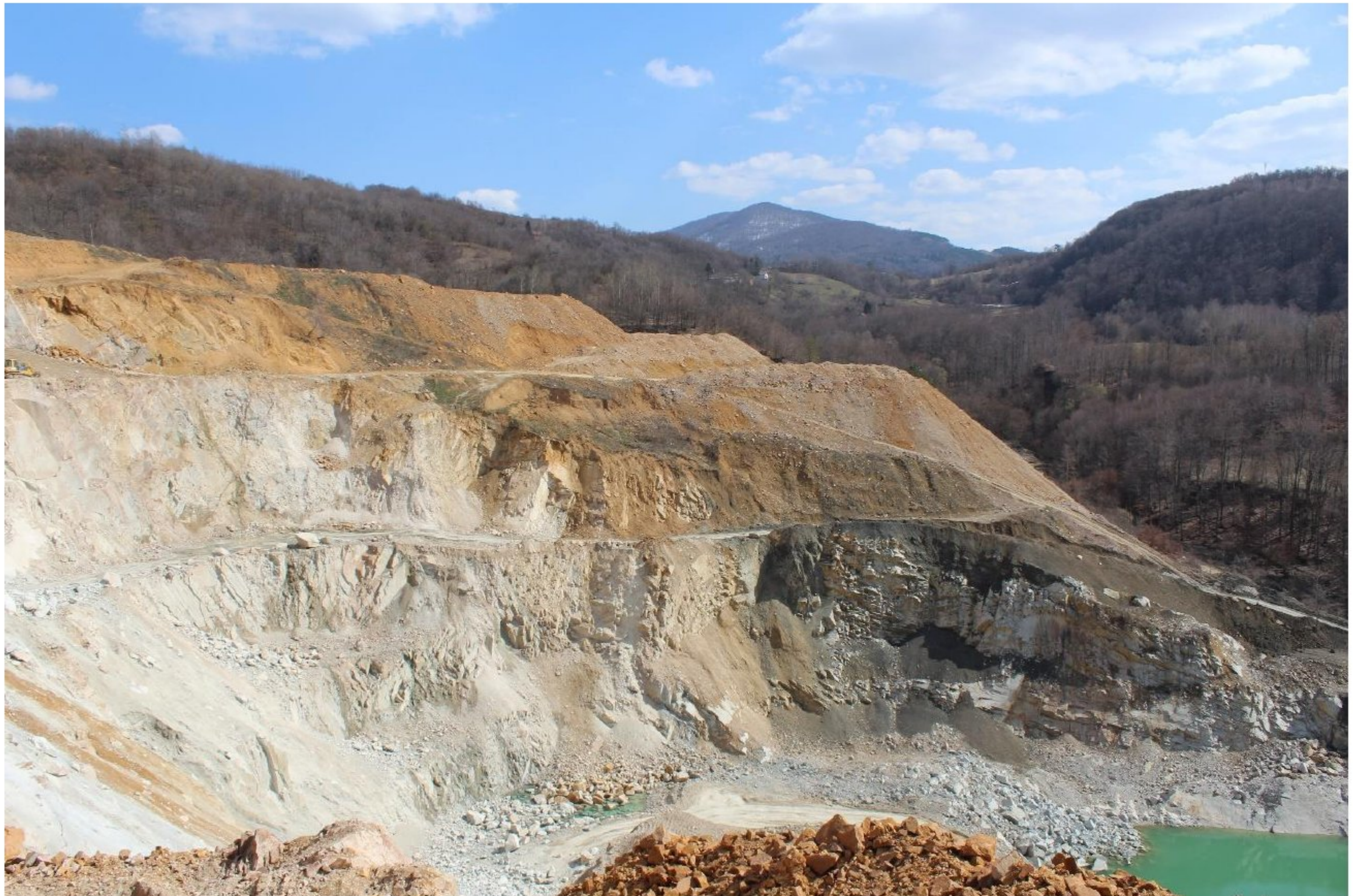
Слика 3.3.23 Примјер двоетажног одлагалишта [54]
