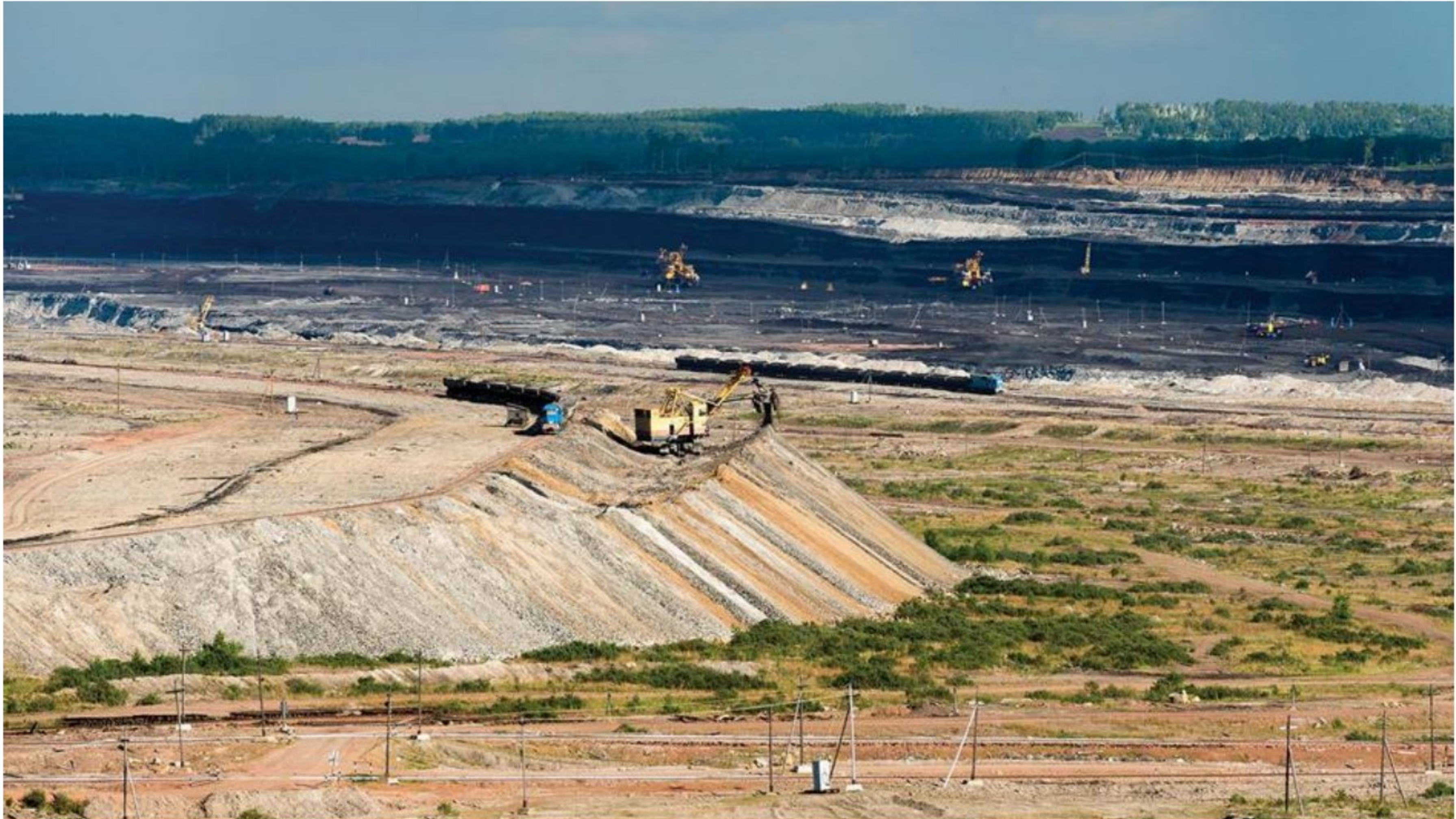
Слика 3.3.15 Примјер формирања одлагалишта у комбинацији жељезничког транспорта и ужетног багера кашикара [59]
