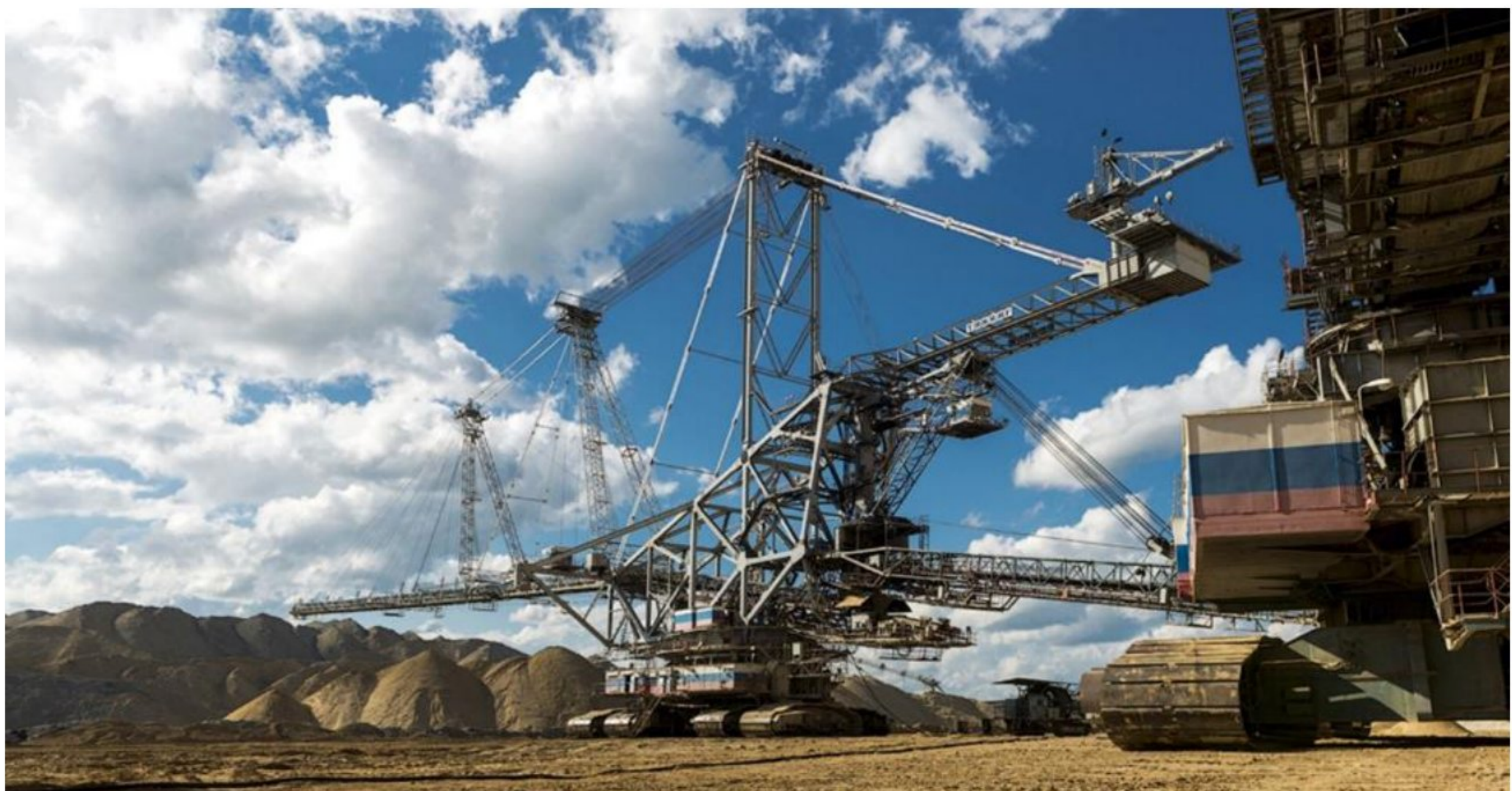
Слика 3.3.13 Формирање одлагалишта одлагачем директно повезаним на роторни багер [57]
