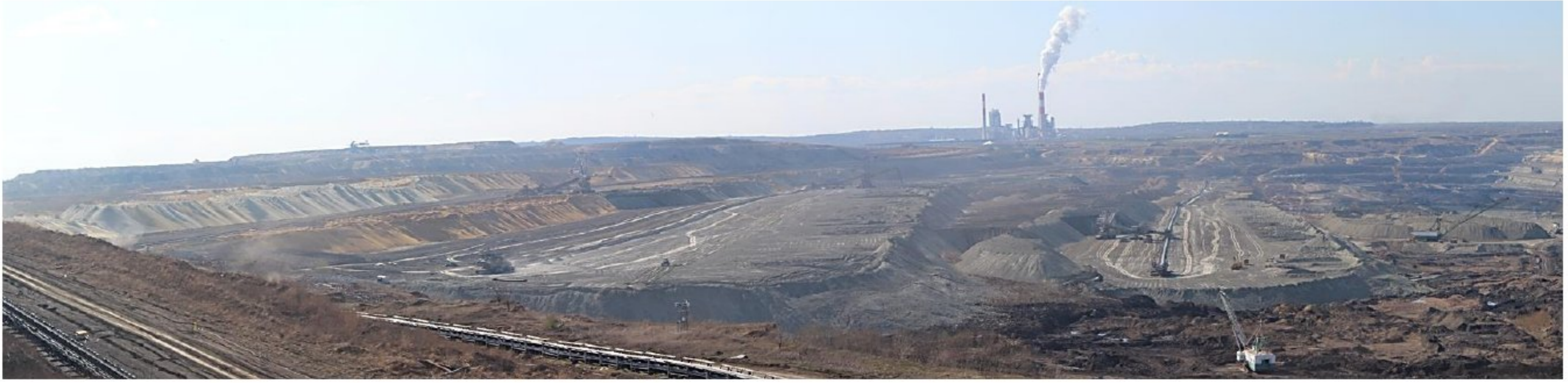
Слика 3.3.24 Унутрашње вишеетажно одлагалиште површинског копа Дрмно [43]
