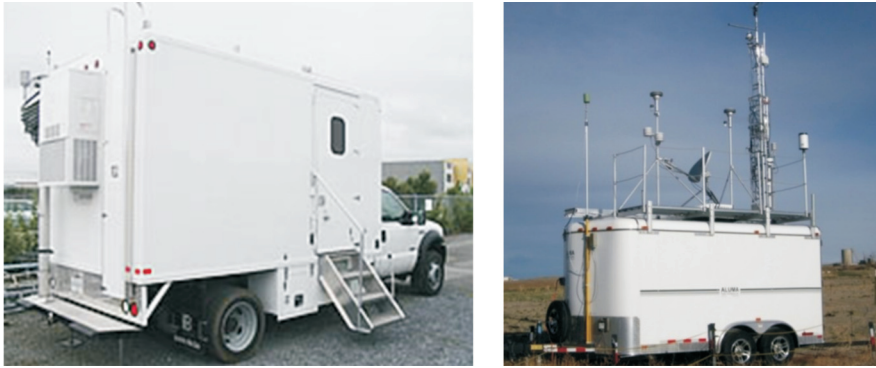
Слика 4.14. Спољашњи изглед мобилне станице за контролу квалитета ваздуха
