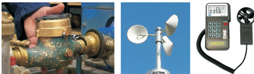
Слика 3.7. Проточни мерачи (сат за проток воде, анемометар за мерење брзине ветра, анемометар за мерење брзине гаса)
