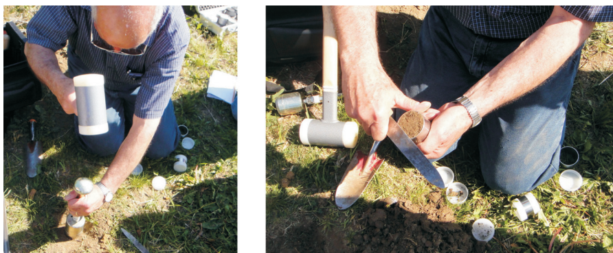
Слика 7.6. Узимање непо ремећеног узорка земљишта
