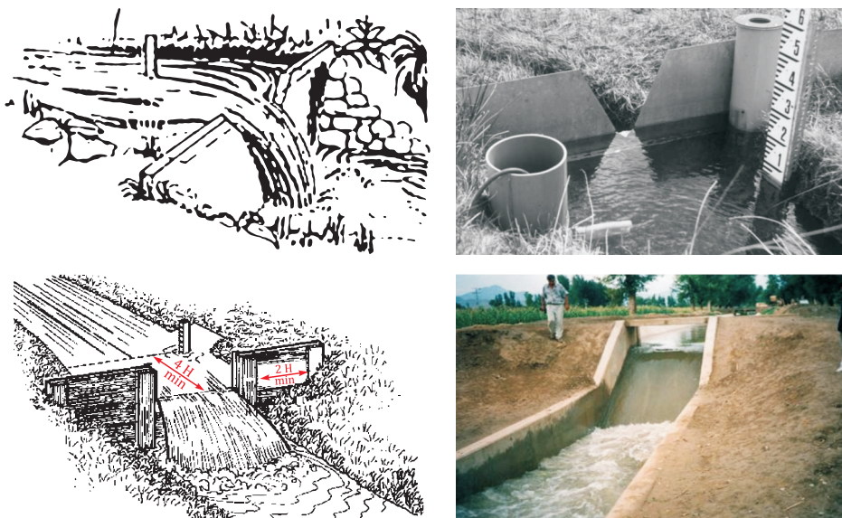
Слика 3.5. Мерни преливи: горе: троугаони са резом под 90^\circ , доле: правоугаони
