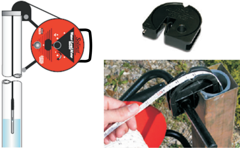
Слика 3.22. Помагала за прецизније одређивање дубине преко мерне траке
