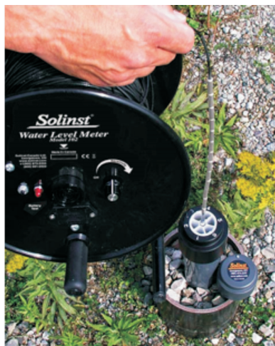
Слика 3.19. Мерење нивоа подземне воде у пијезометру
