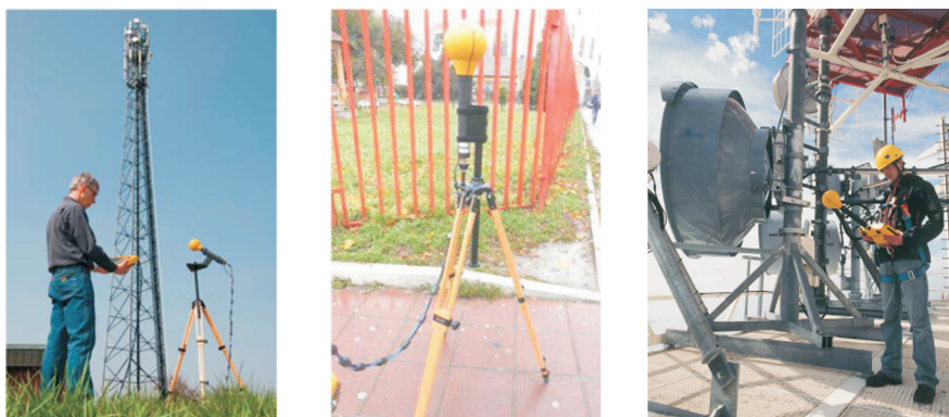
Слика 6.5. Практично мерење нејонизујућег зрачења на мерном месту
