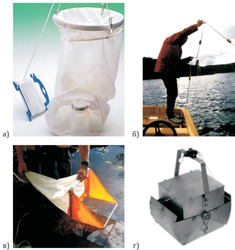
Слика 8.10. Опрема за узорковање: а) планктонска мрежица, б) Сурберова мрежа за прикупљање бентофауне, в) повлачна мрежа за прикупљање рибе, г) багер типа Екман
