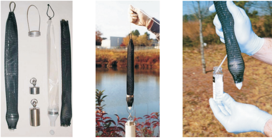
Слика 3.27. Посуда ("врећа") за ручно узимање узорака воде из пијезометара: комплет - посуде и пратећег прибора (лево), вађење вреће из пијезометра (у средини), пражњење вреће (десно)
