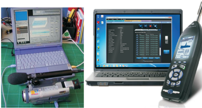
Слика 5.12. Спрегнути систем једноставног уређаја за мерење буке са рачунаром
