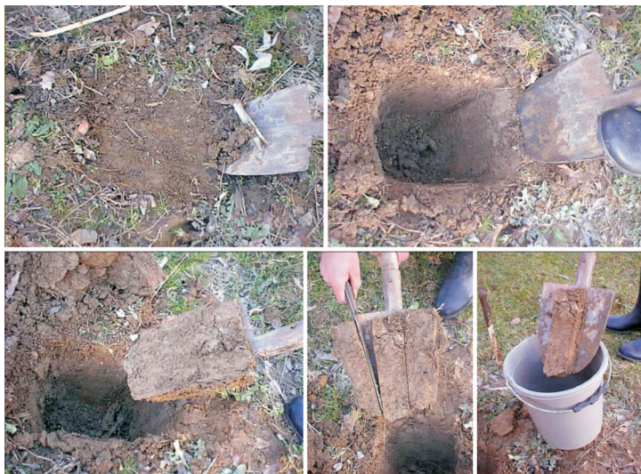
Слика 7.11. Узимање узорака површинског слоја
