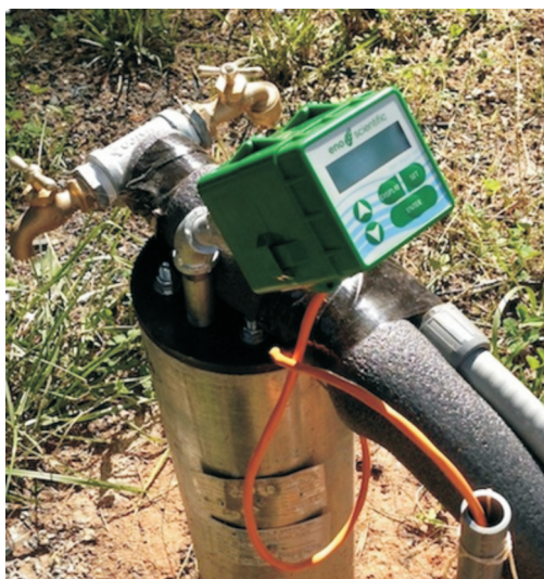
Слика 3.25. Мерење нивоа воде у пијезометру ултразвучним мерачем
