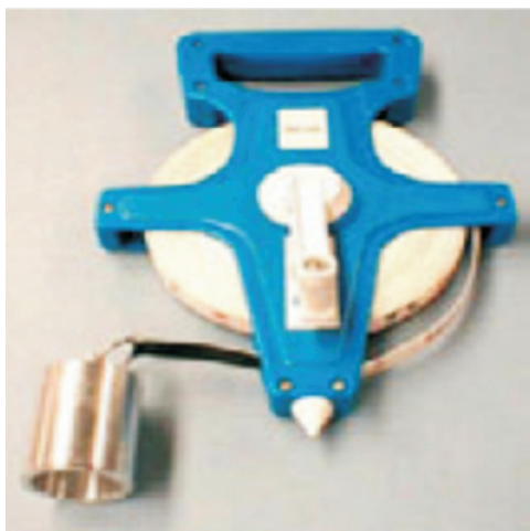
Слика 3.18. Пантљика и пиштаљка за мерење нивоа подземне воде
