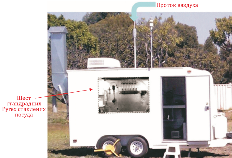
Слика 4.18. Ток ваздуха кроз гасне анализаторе смештене у мобилној станици
