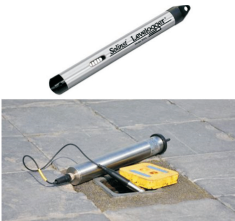
Слика 3.23. Дајвер за одређивање дубине воде у пијезометрима
