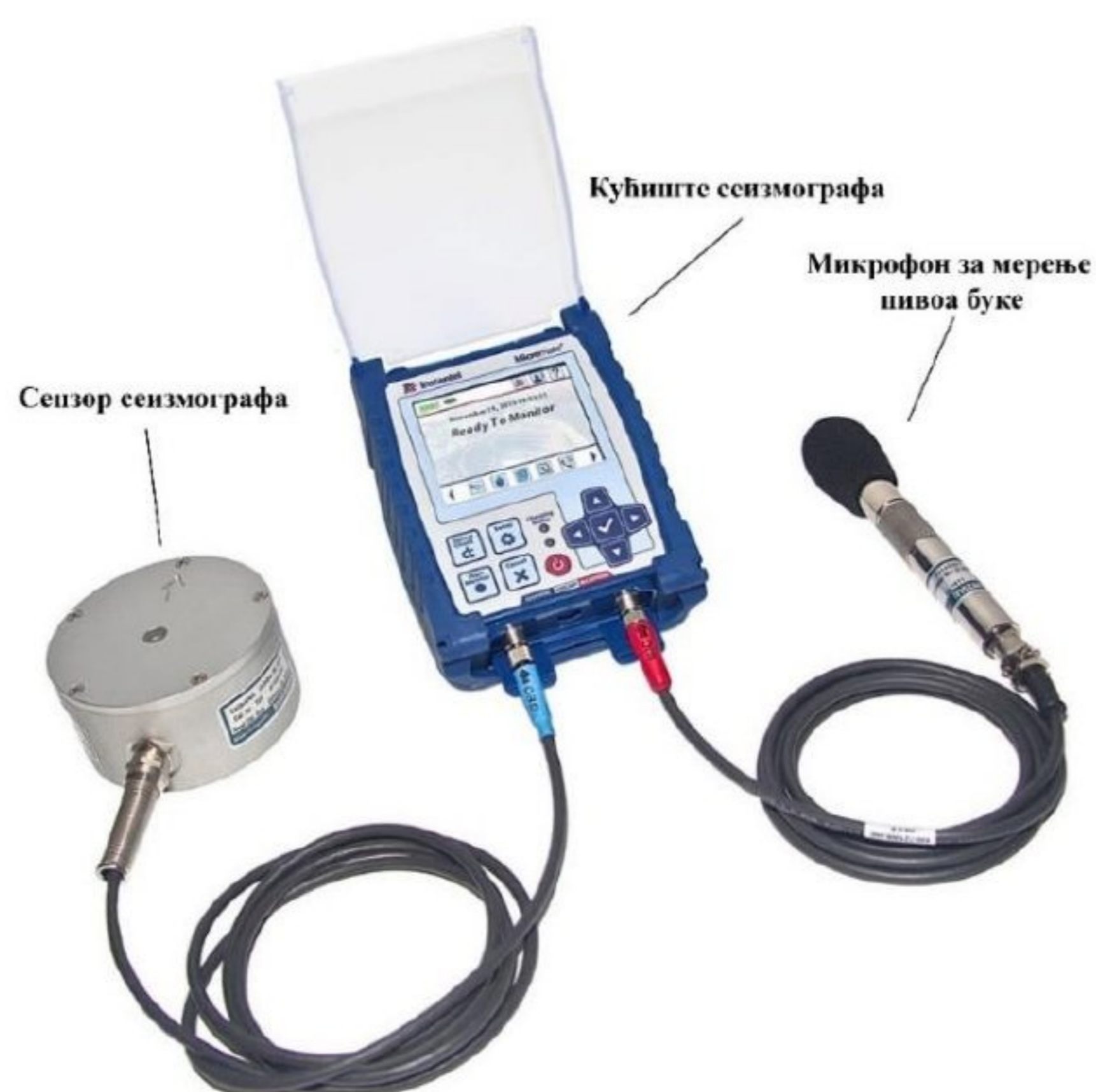
Слика 3.11 Модел “Instantel Micromate” сеизмографа за мерење потреса услед минирања [54]
