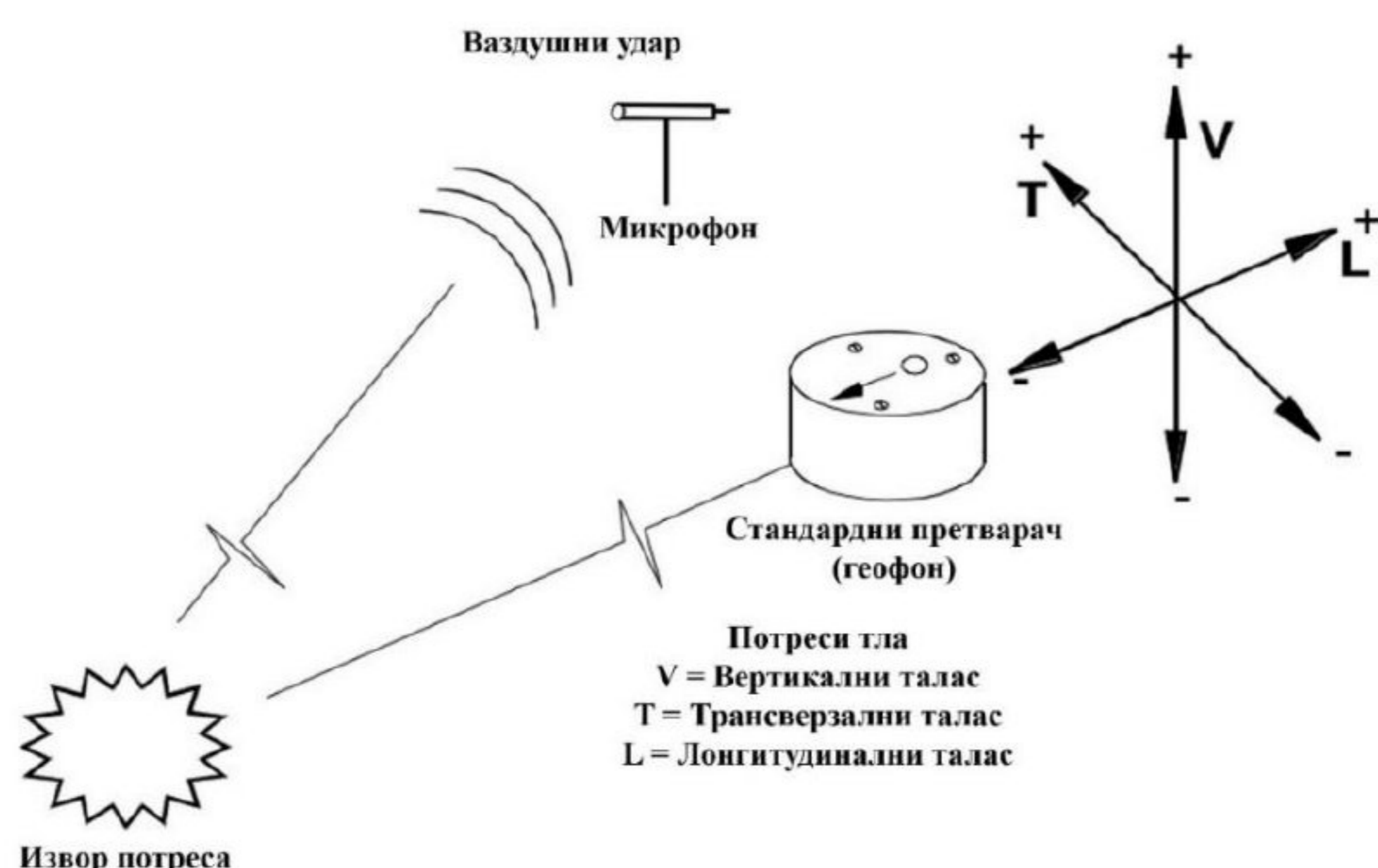
Слика 3.10 Шематски приказ мерења потреса тла у односу на место минирања [53]
