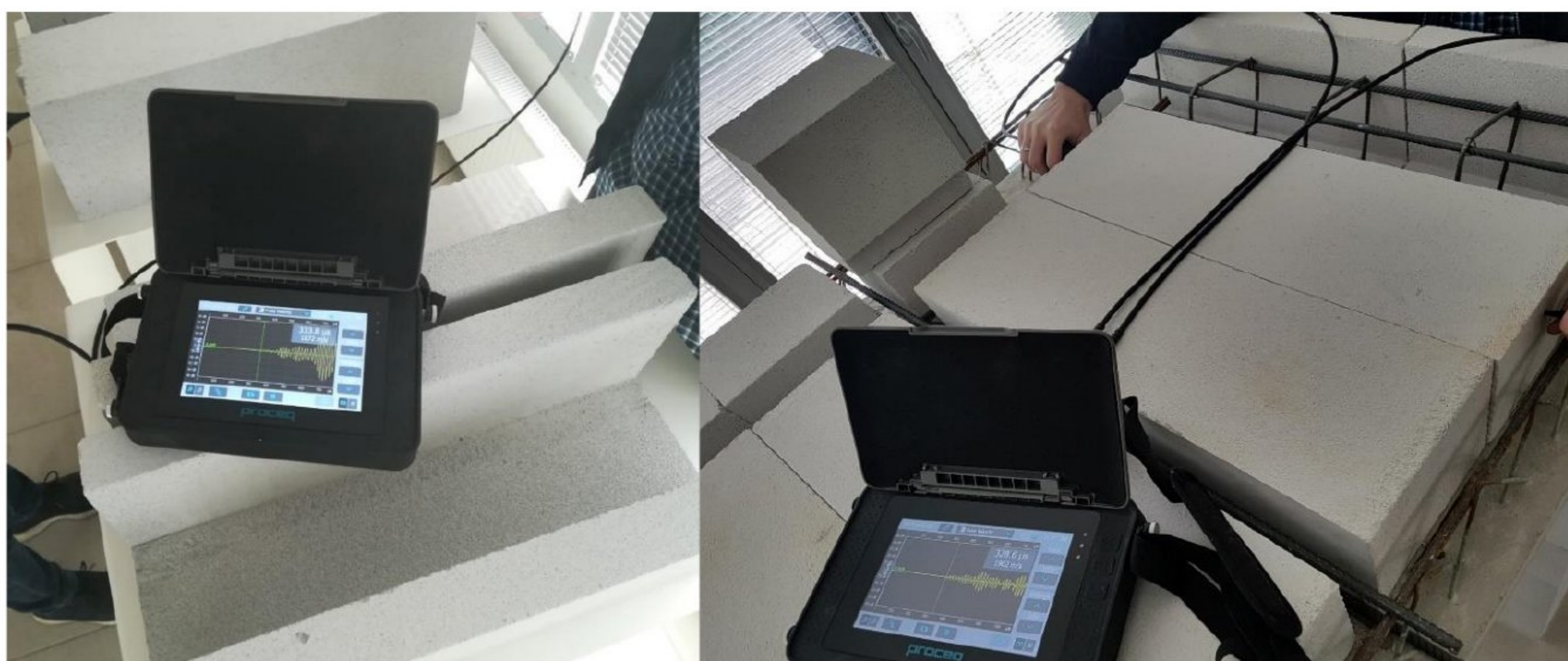
Слика 5.4 Приказ мерења брзине уздужних таласа на блоковима са инструментом [1]
