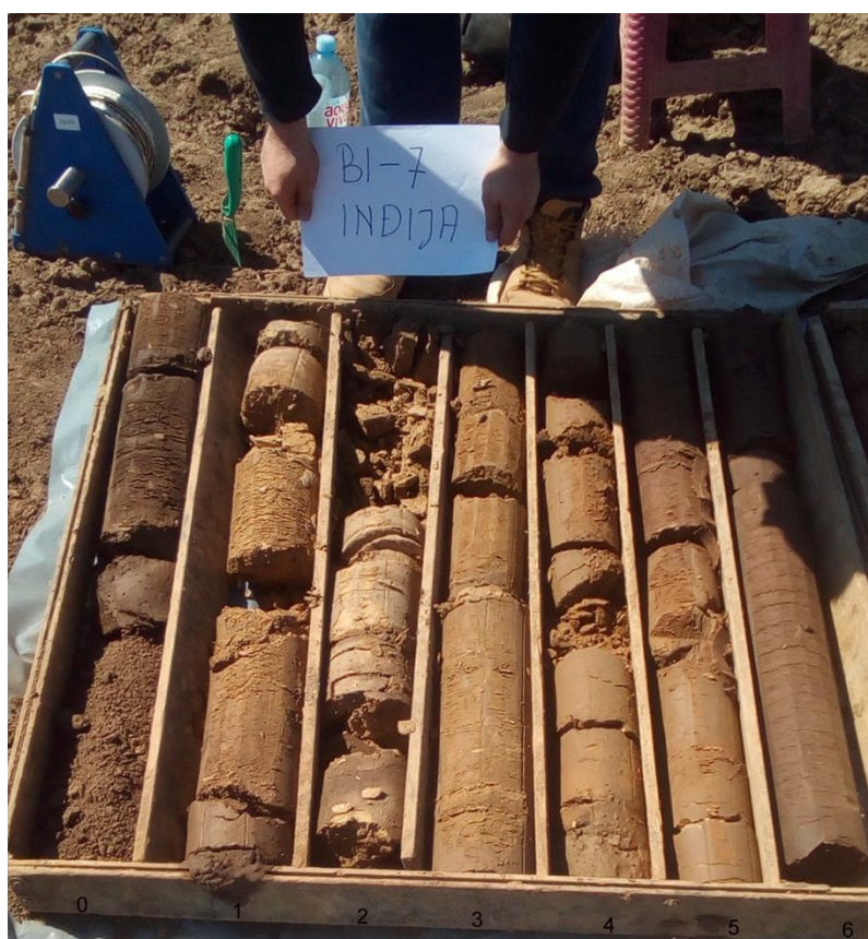
Slika 13. Izgled jezgra bušotine BI-7 (prvi sanduk) pre kartiranja i uzorkovanja (foto: S.Obradović, april 2018. godine)
