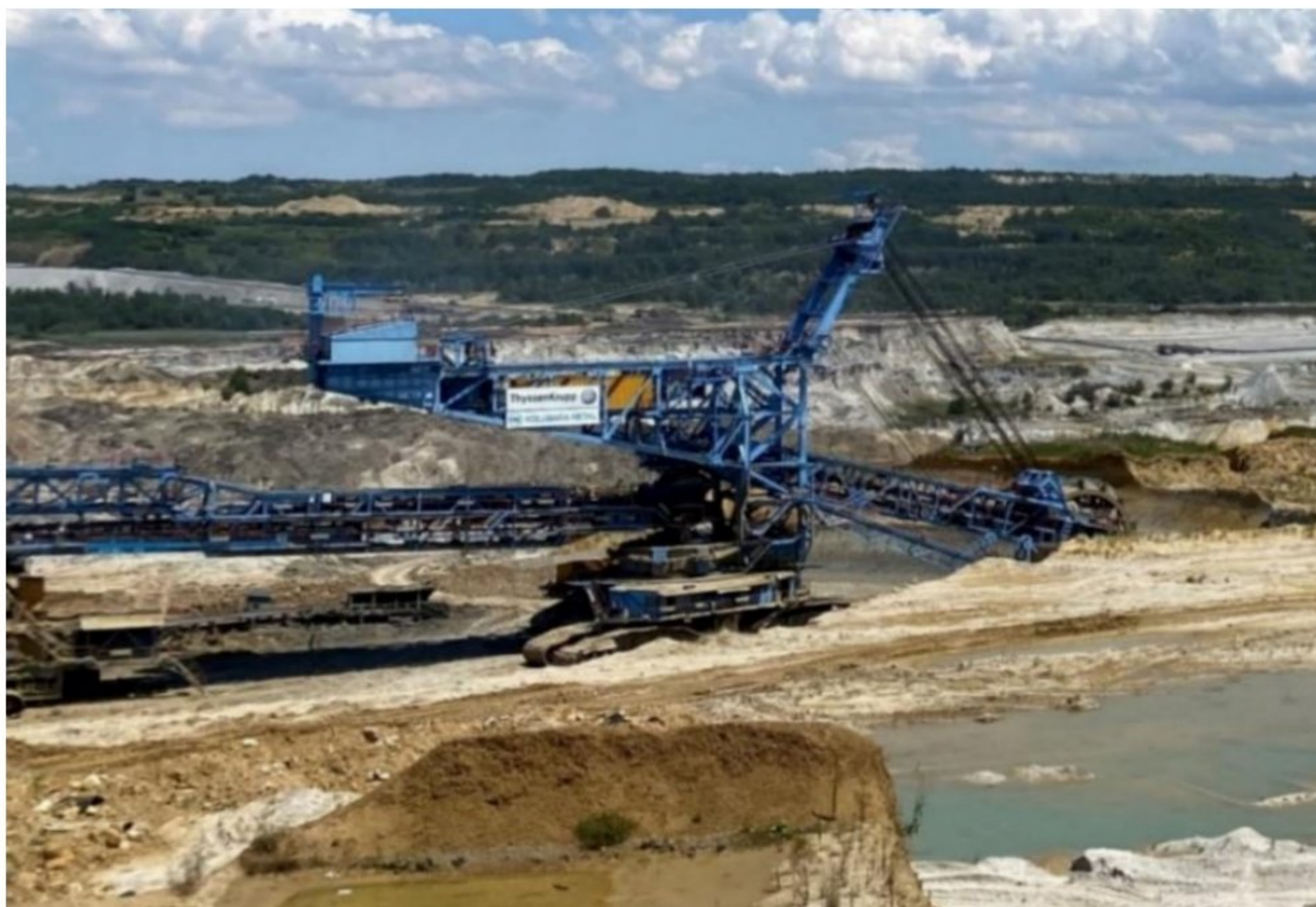
Слика 4.9. Роторни багер SchRs 1760 на површинском копу Поље Д Колубара (приватна архива)
