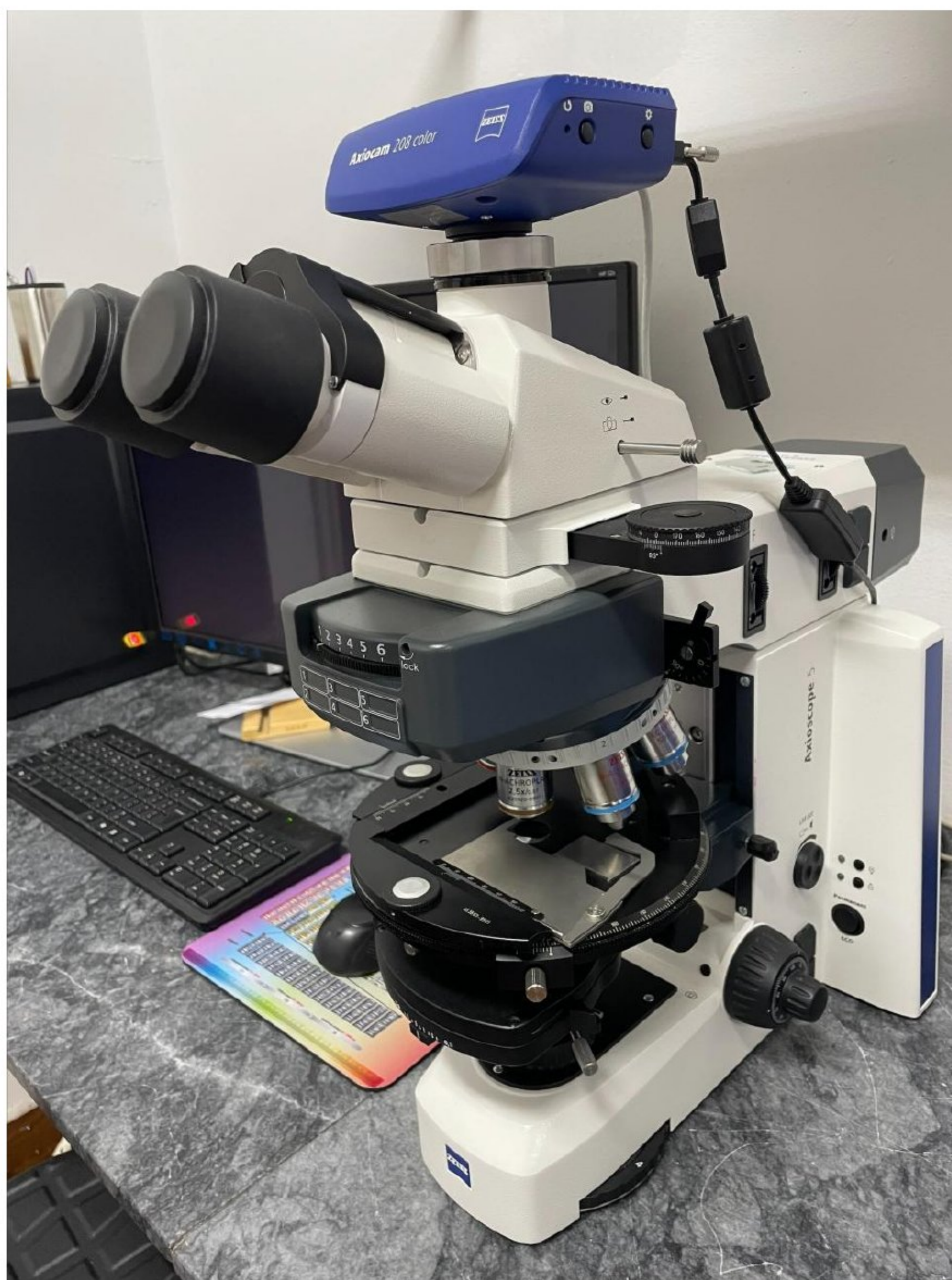
Slika 4. Petrografski polarizacioni mikroskop za propuštenu svetlost Carl Zeiss, Axioscope 5, kamera Zeiss, AxioCam 208 color
