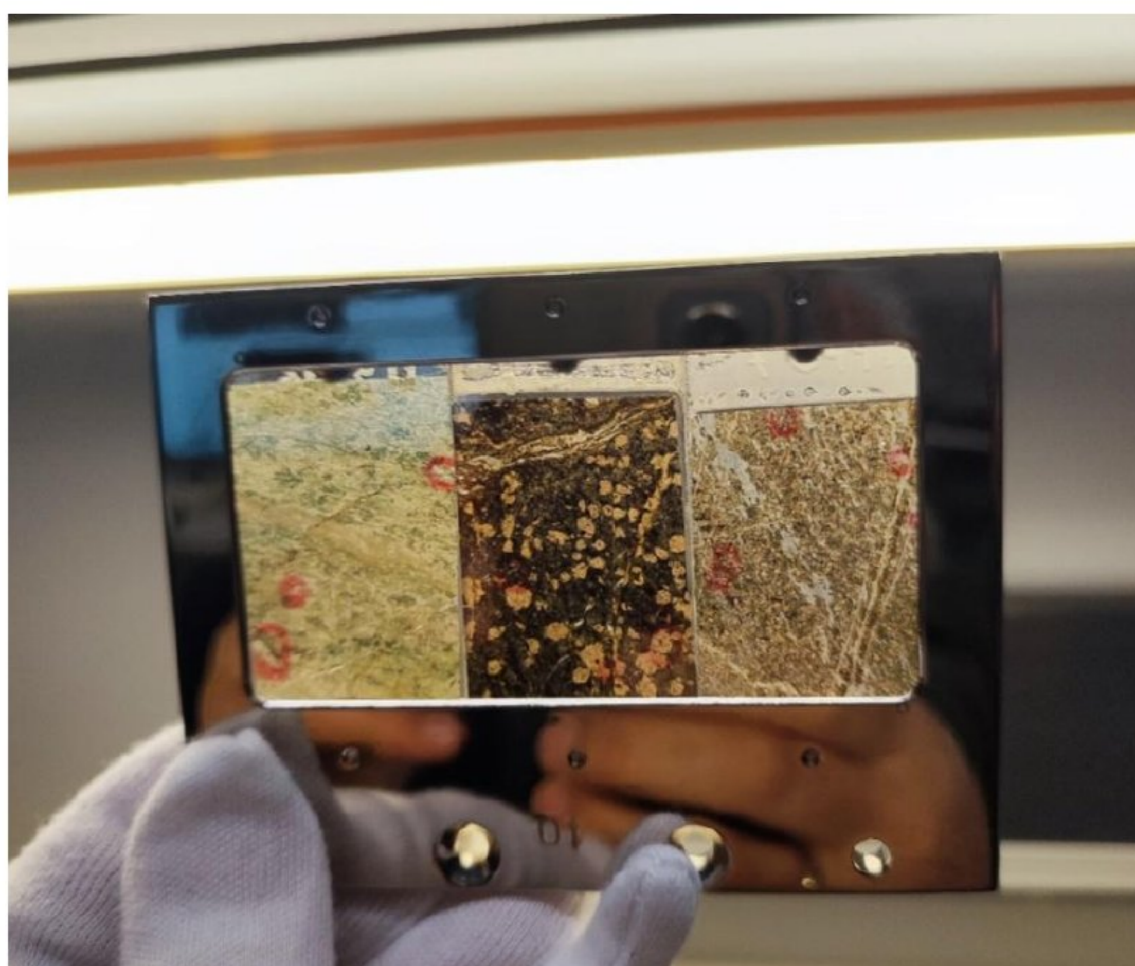
Slika 6. Izgled petrografskih preparata pripremljenih za analiziranje mikrosandom
