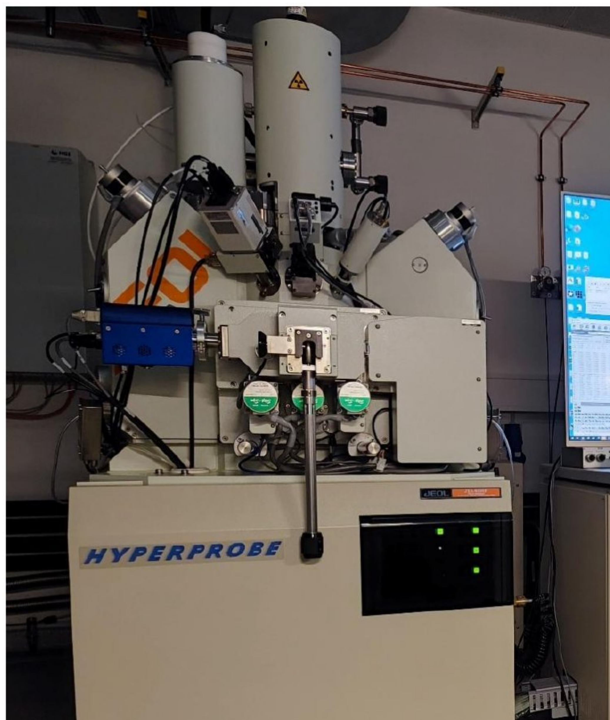
Slika 5. Elektronska mikrosonda na Institutu za geofiziku, geochemiju i mineralogiju u Minsteru, Nemačka, marke Jeol JXA-8530F
