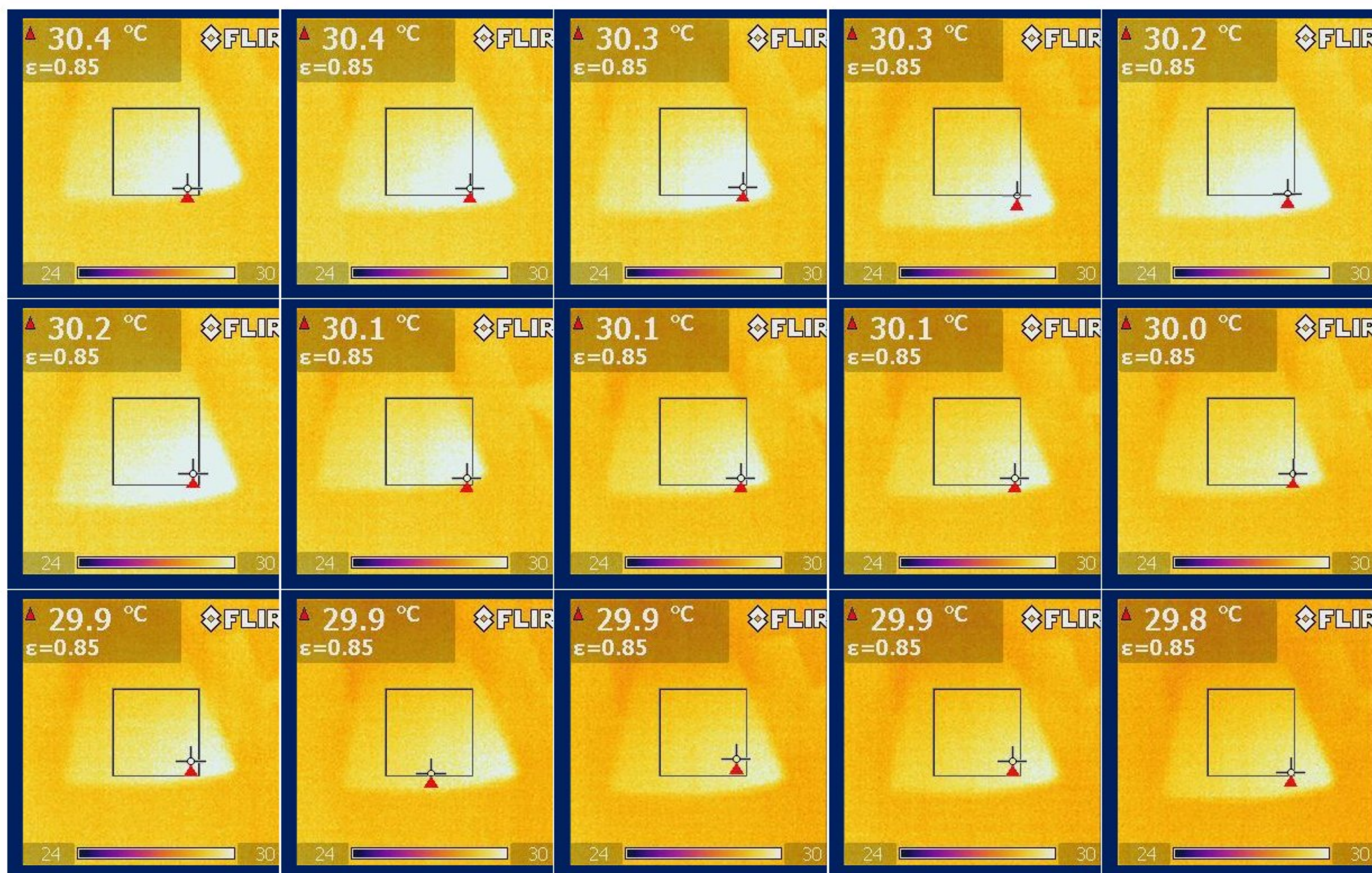
Slika 36 Добијени термограми емисије топлоте на зубу при копању у десну страну
