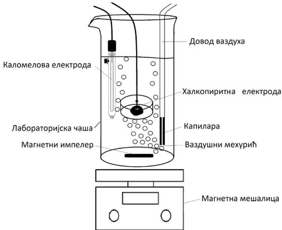
Слика 19 - Апаратура за одређивање оксидо-редукционог потенцијала
