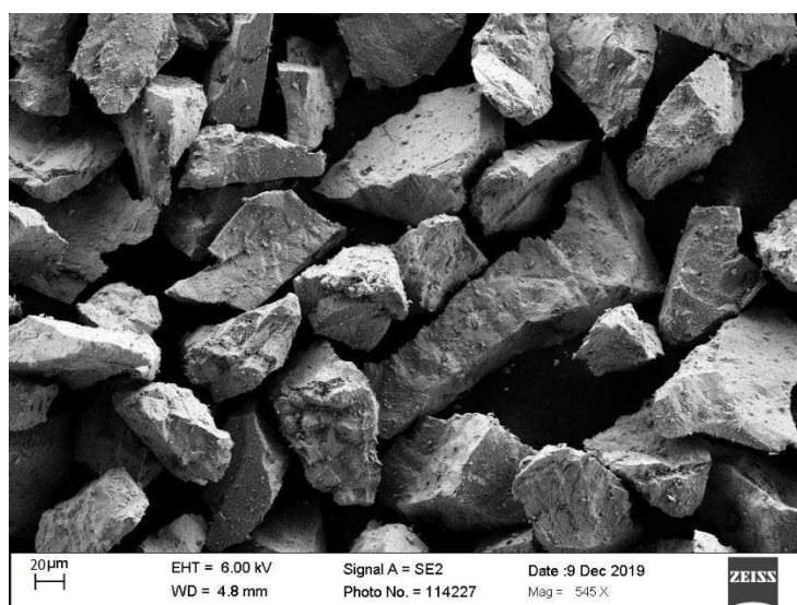
Слика 29 - Зрна узорка халкопирита
