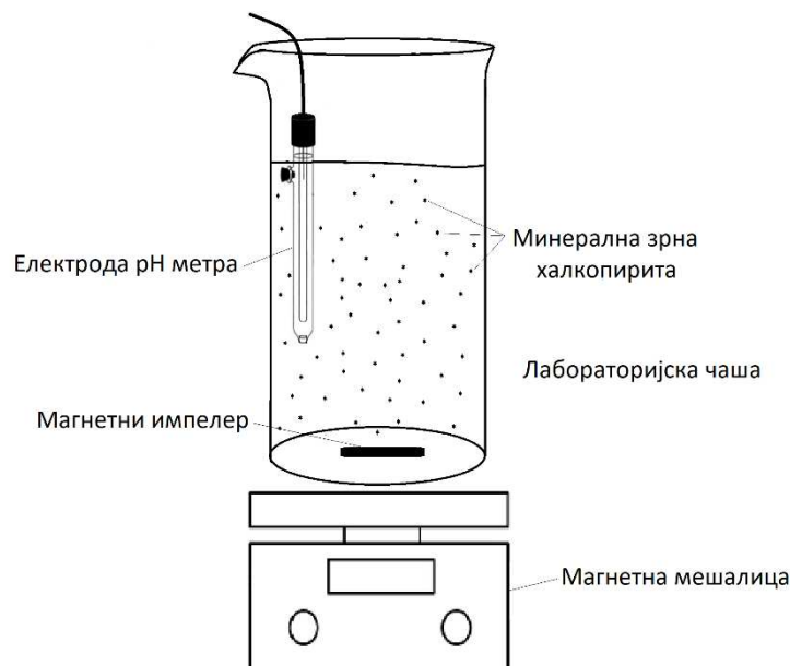
Слика 21 – Апаратура за кондиционирање узорка халкопирита
