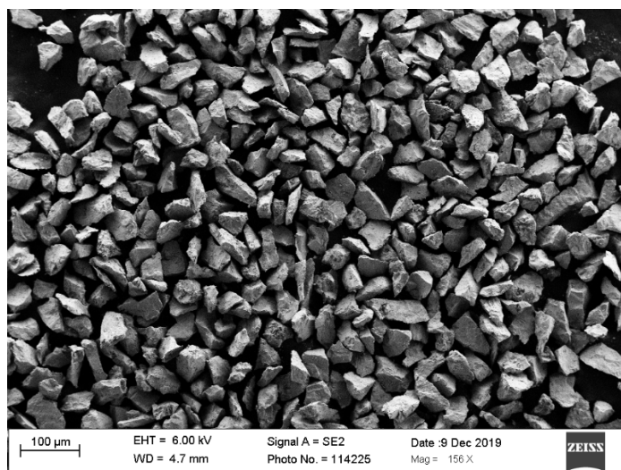
Слика 27 - Зрна узорка халкопирита
