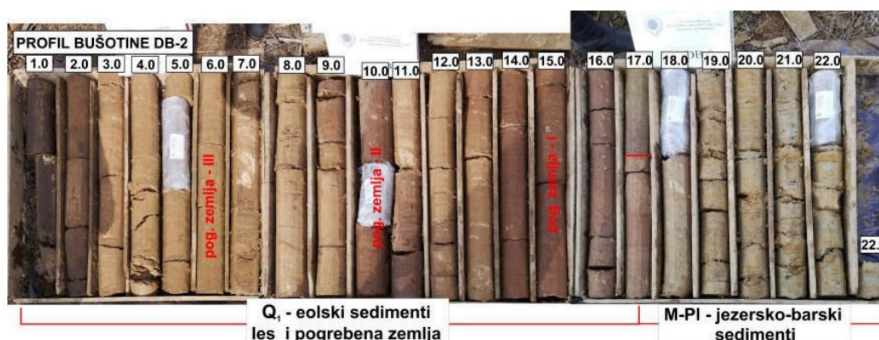
Slika 3. Fotografija jezgra dopunske bušotine DB-2
