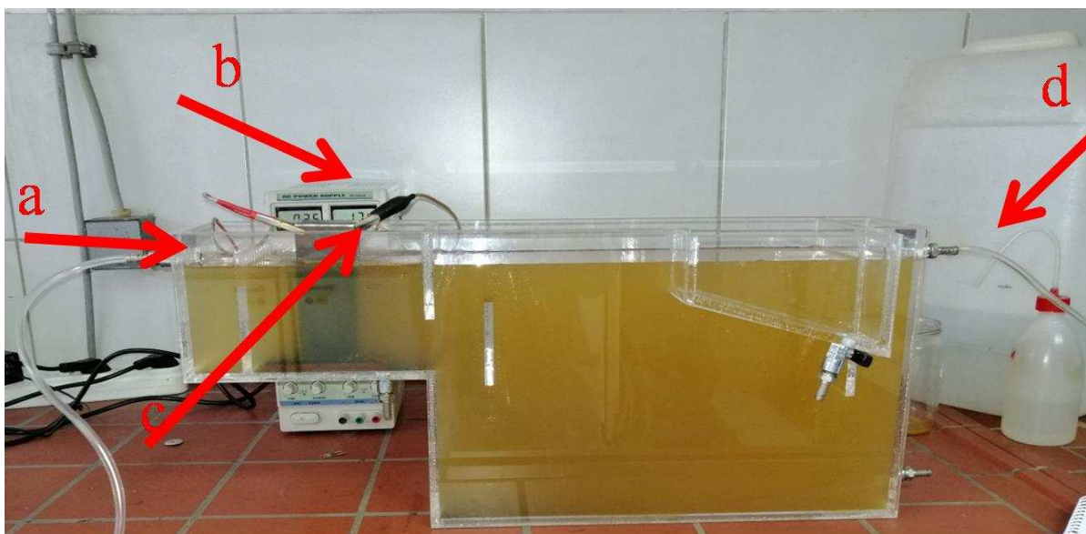
Slika 2. Prikaz reaktora sa Fe elektrodama (a-ulaz, b-izvor jednosmerne struje, c-elektrode, d-izlaz)
