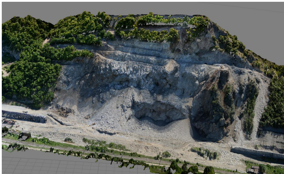
Slika 1. 3D model terena dobijen analizom snimaka dobijenih primenom kamere visoke rezolucije montirane na platformu drona
