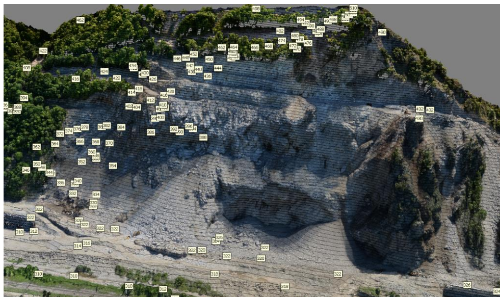
Slika 2. Georeferenciran 3D model sa prikazom izolinija terena
